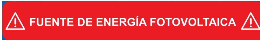
Ilustración 3. Etiquetas de seguridad para circuitos solares
