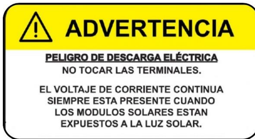
Ilustración 4. Aviso de riesgo eléctrico para equipos del sistema eléctrico
